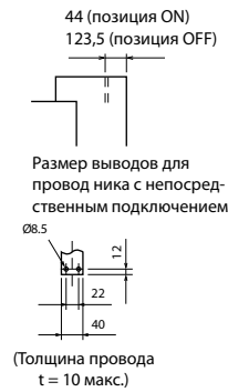
Отверстия под провода для прямого подключения
